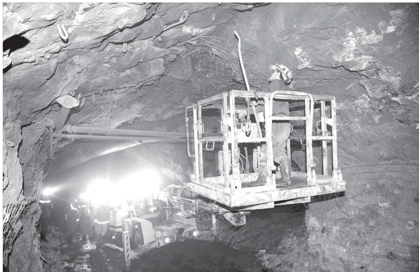
Дополнительные кровлеоборочные машины приходят на норильские рудники по специальной программе предотвращения заколообразования и уменьшения травматизма
