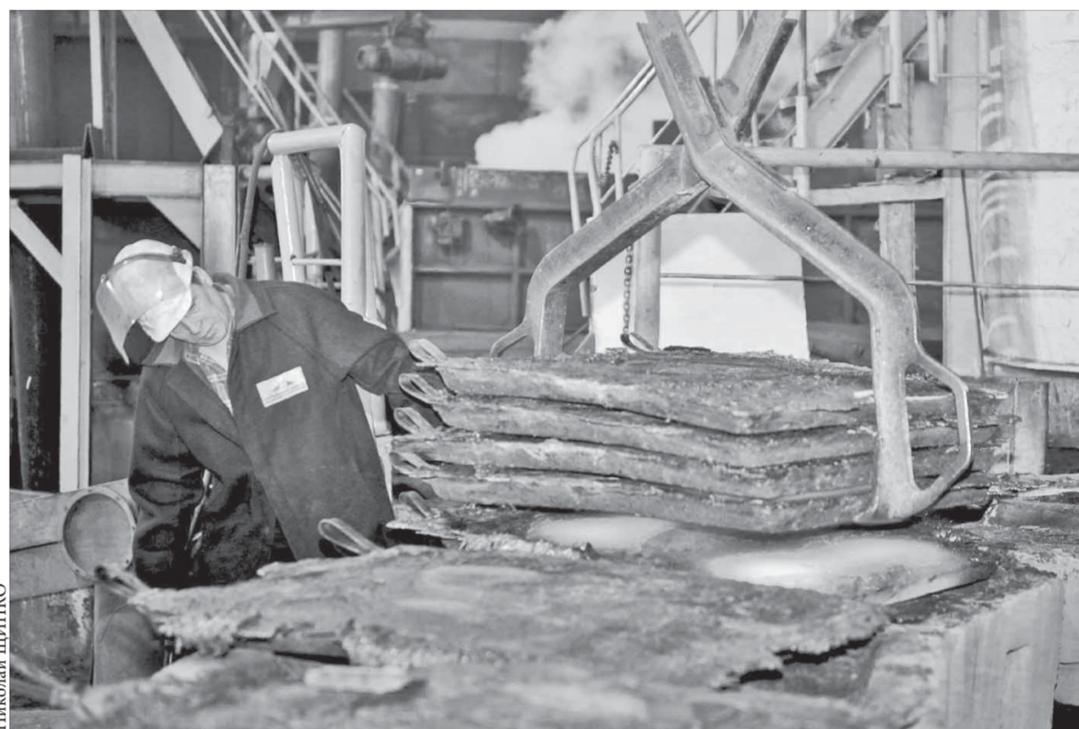
В перспективе съем и пакетирование черновых анодов будет осуществляться автоматически
