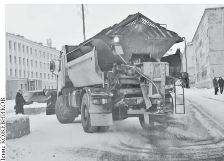
Ежедневно на улицах города рассыпают тонны граншлака
