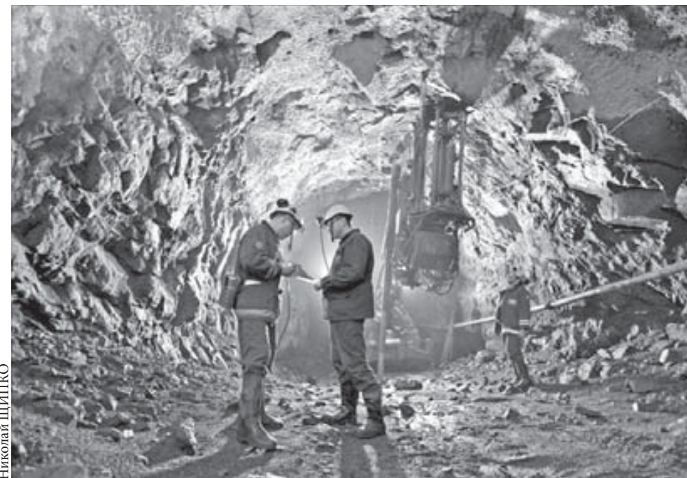
Веерное бурение с созданием камер с увеличенным выемочным пространством – ноу-хау “Октября”
