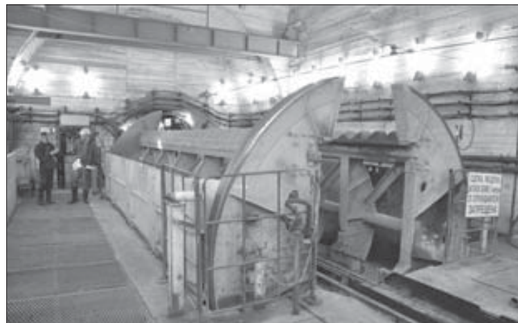
Опрокидыватель отправляет руду в дробилку
