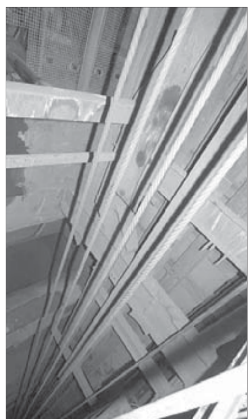
Головные канаты скиповых стволов уходят на километровые глубины
