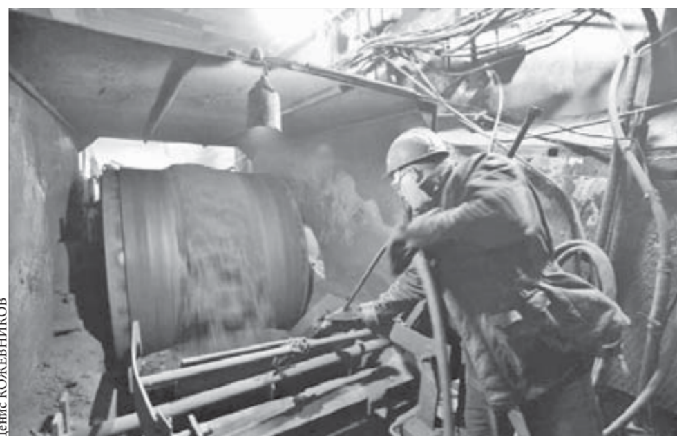
Шихта с транспортеров подается в бункеры
