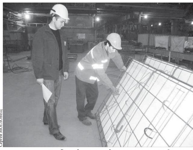
В цехе сборного железобетона идет проверка готовой продукции
