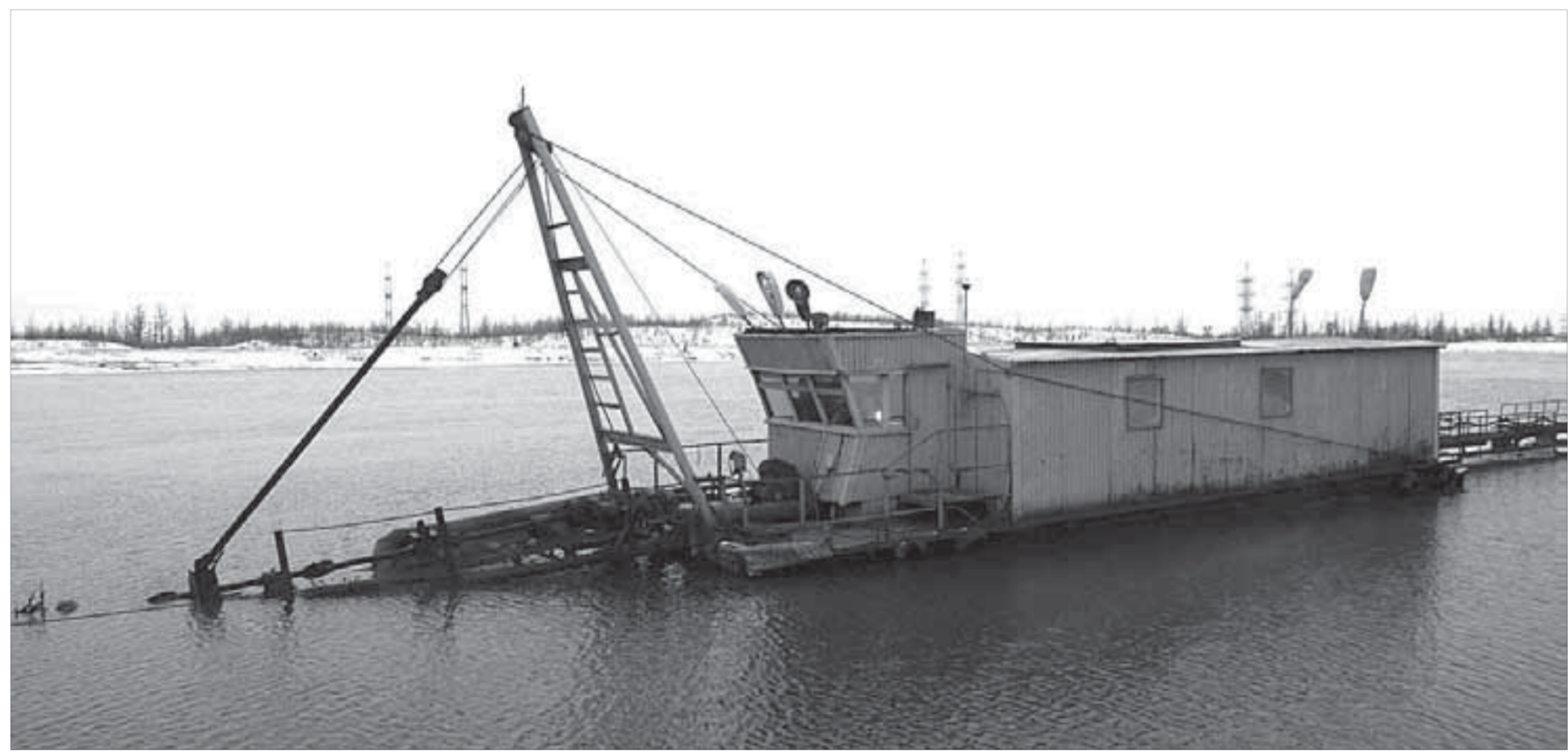
Земснаряд – полноценное судно, подчиняющееся требованиям Речного регистра
